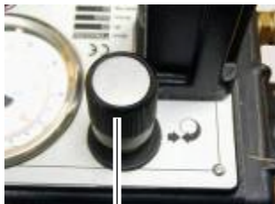
Valvola di aggiustamento fine della pressione
