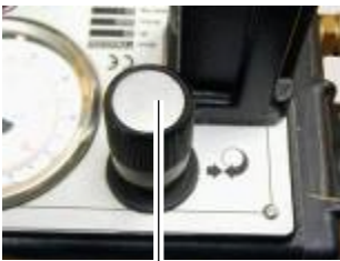
Válvula de regulación fina de la presión
